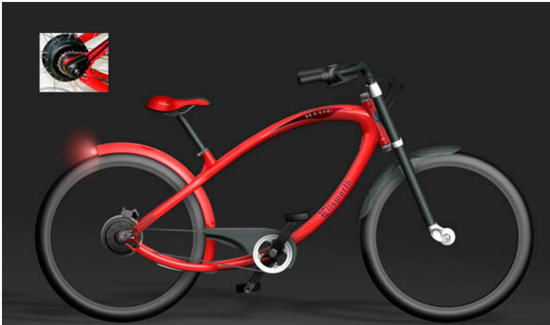
De Ride™ door Ellsworth (illustratie) met de NuVinci-CVP (inzet) zoals geïnstalleerd in een prototype
